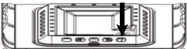
Подержите регулятор нажатым еще 3-5 секунд, чтобы активировать защитный механизм. Если после нажатия регулятора и его отпускания розжиг не осуществился, повторите нажатие с удержанием в 15 секунд. Отрегулируйте интенсивность пламени поворотом регулятора. Чтобы выключить духовку по завершению готовки, поверните регулятор в верхнее положение («ВЫКЛ», «0»).
