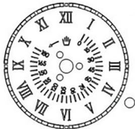
Настройка времени суток: нажмите на кнопку рядом с таймером, и в нажатом состоянии поверните кнопку против часовой стрелки.
