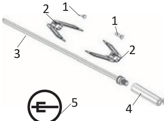
1. Если ваш прибор оборудован вертелем, ослабьте болт(1) на креплении v-образных деталей(2) шампур(3), который следует продеть через курицу. После чего курица фиксируется при помощи v-образных деталей(2), болт(1) завинчивается.
