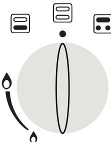
В моделях с функцией автоматического розжига, чтобы зажечь нижнюю газовую горелку духовки, нажмите на регулятор газовой духовки и, не отпуская, поверните его против часовой стрелки в позицию «сильное пламя». Чтобы зажечь верхнюю газовую горелку (гриль) духовки, нажмите на регулятор газовой духовки и, не отпуская, поверните его по часовой стрелке.
