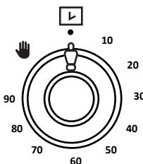
При наличии данного типа таймера отрегулируйте время готовки, поворачивая регулятор времени (диапазон настройки 1 мин.-90 мин.). По завершении сработает звуковой сигнал.
