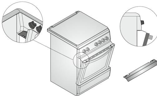
В комплекте некоторых моделей плит имеется теплозащитный экран, предназначенный для защиты панели управления и регуляторов от перегревания при работе гриля. Открыв дверцу духовки, зафиксируйте теплозащитный экран в соответствующих пазах под панелью управления, как показано на рисунке выше. После этого, медленно закрывая дверцу, зафиксируйте ее в приоткрытом положении. Теперь можно пользоваться грилем.
